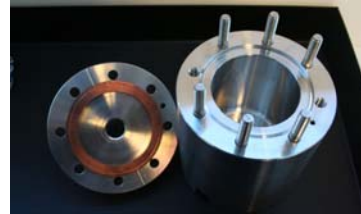
Rostfritt hölje med palladium- membran och UHV förslutning
