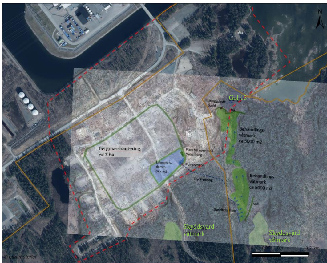
Figur 3-3. Alternativ lakvattenrening genom ledning till våtmarksområdet söder om verksamhetsområdet. Röd streckad linje markerar verksamhetsområdet i Söderviken, orange linje markerar fastighetsgränsen för Forsmark 6:20.
