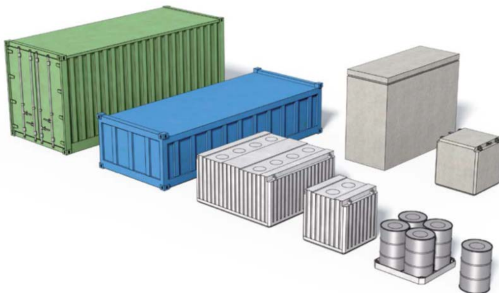
Figur 5 Exempel på emballage som kommer att användas. Helhöjdscontainer, halvhöjdscontainer, fyrkokill, plåtkokill, fatbricka, fat, betongtank, betongkokill.
