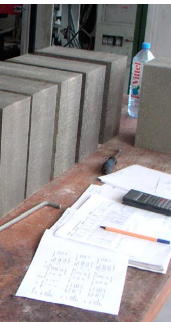
Block av lera för att återfylla deponeringstunnlar.
