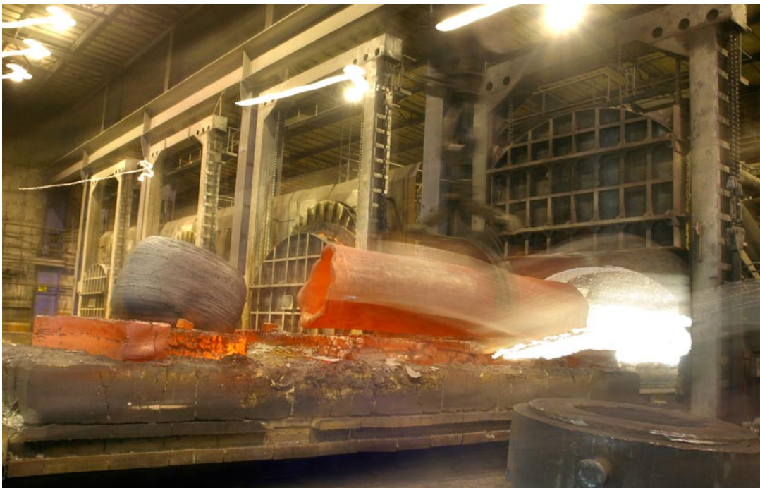
Tillverkning av kopparkapslar genom smide.
