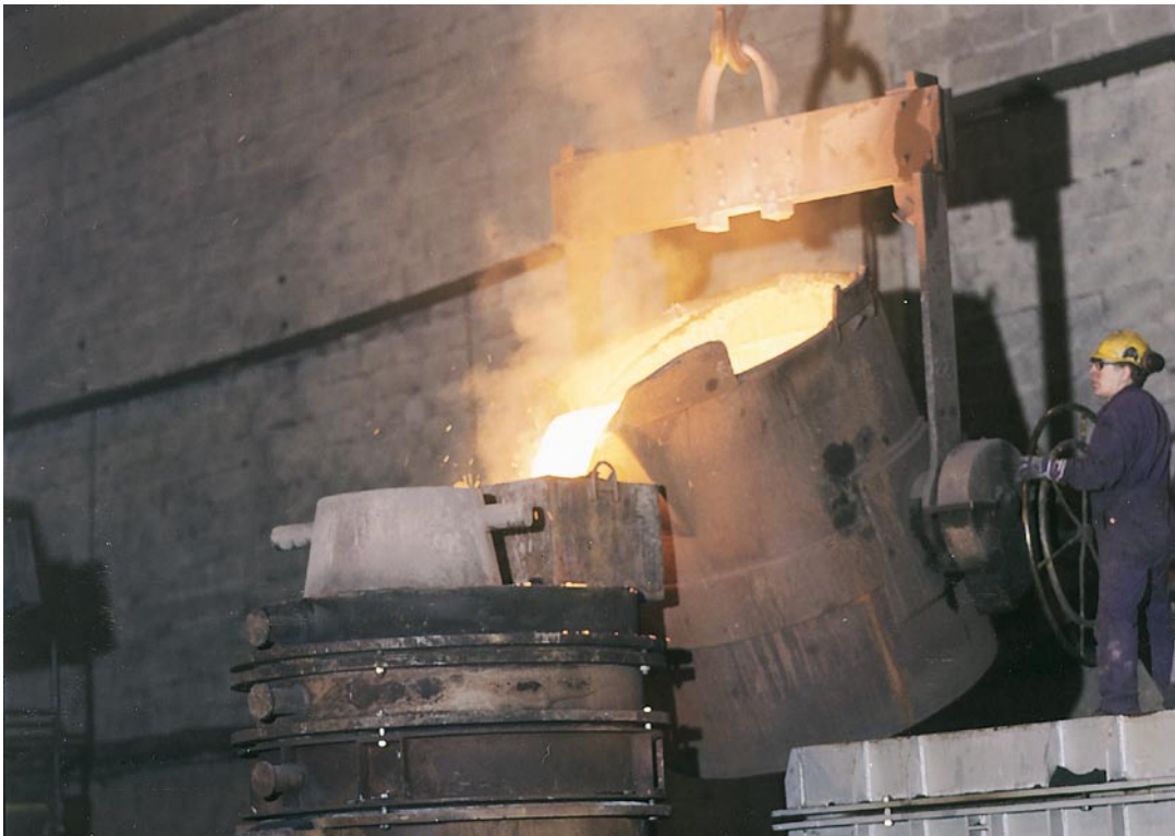
Gjutning av insatsen till kapseln.
