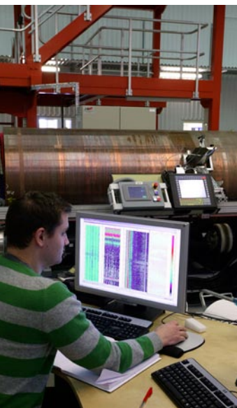
Kontroll av kapselns kopparhölje.
