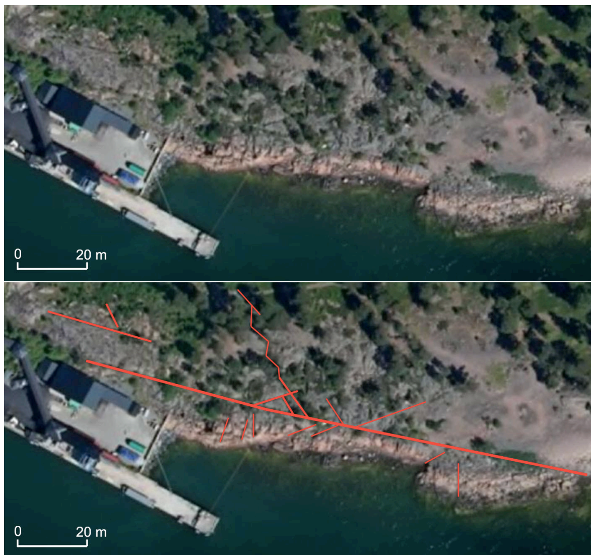
Fig. 4. Grisslehamn med sprickor som tveklöst anger differentiella berggrunds rörelser efter istiden. Dessa sprickor ingår i Grisslehamn–Tierp linjen (Fig. 1) och visar att denna linje var aktive (rörde sig) efter det att isen lämnat (eller var på väg att lämna i norra Uppland).
