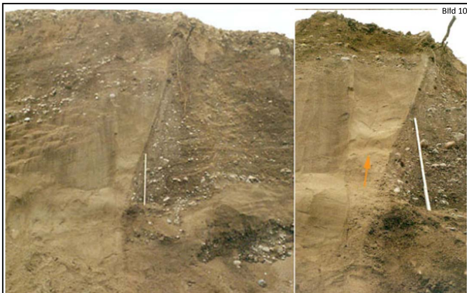
Fig. 6. Älvkarleby liquefaction av sand och grus med en "venting pipe" (gul pil) som anger utomordentligt starkt tryck. Professor Franck Audemard, specialist just på liquefaction, angav en motsvarande jordbävningsmagnitud på M 8 till M > 8 .
