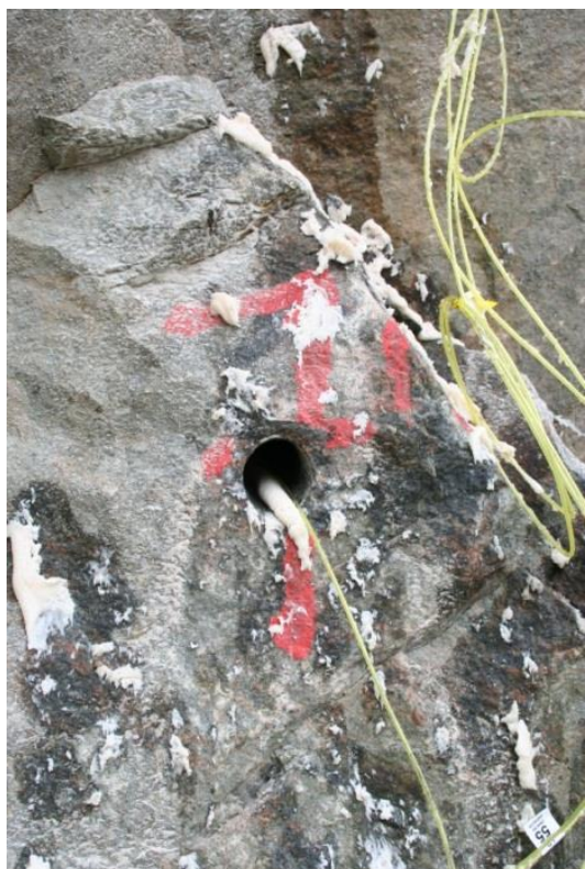
Figur 3. Emulsionspill i samband med laddning.
