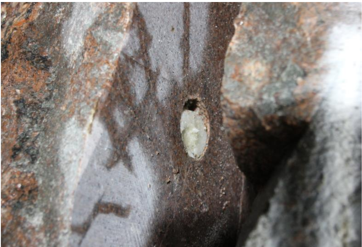
Figur 2. Odetonerad emulsion i ett så kallat glasöga (laddningskoncentration 1,2 kg/m).
