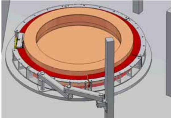
Figur 3. En skiss av det nyutvecklade (2011) gasskyddet som har använts hittills under svetsning.
