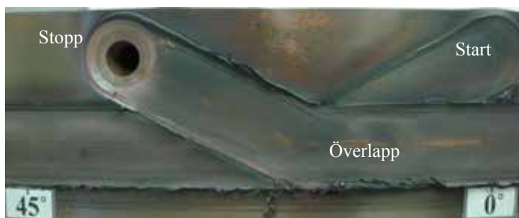
Figur 4. En bild av start-, överlapp- och stoppområdet av svets FSW75. Det är dessa områden som också uppvisar störst ansamling av oxidpartiklar.
