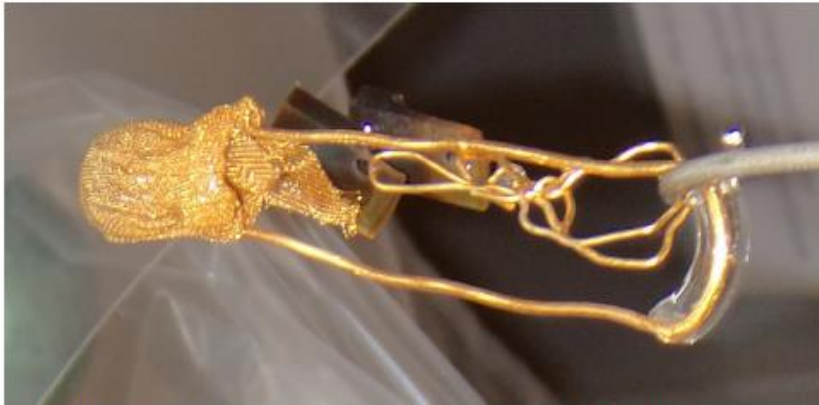
Figur 1: 4U8. Guldkorg samt prov efter 259 dagar under argon, 24 C, 330 µM Cr(VI).
