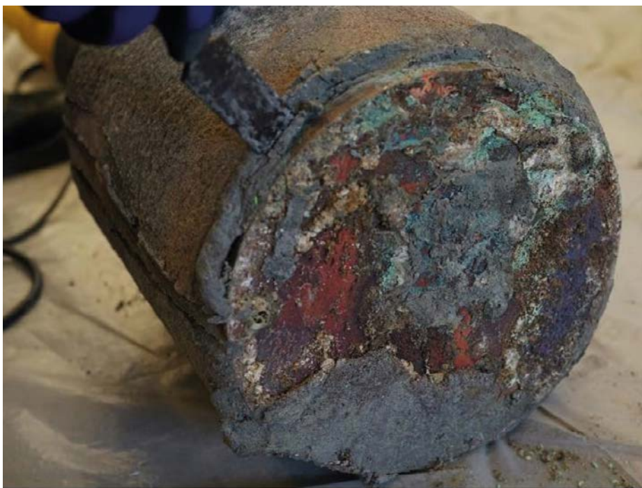
Bild på med all sannolikhet syrgasfri kopparkorrosion på bottenplattan i LOT-försökspaketet A3 efter 20 år. SKB har inte visat någon bild på den ändå varmare mest korroderade ytan på kopparröret. (Källa: SKB rapport TR-20-14). Mer utförlig beskrivning av LOT-försöket finns i MKG:s tidigare nyhetsbrev 3-2020 och 2-2020.
