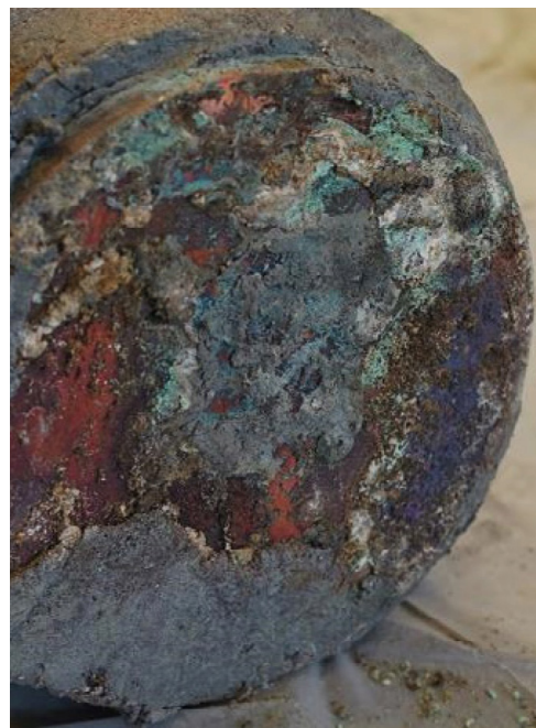
Bildtext: Med all sannolikhet syrgasfri kopparkorrosion på bottenplattan i LOT-försökspaketet A3 efter 20 år. (Källa: SKB rapport TR-20-14).
