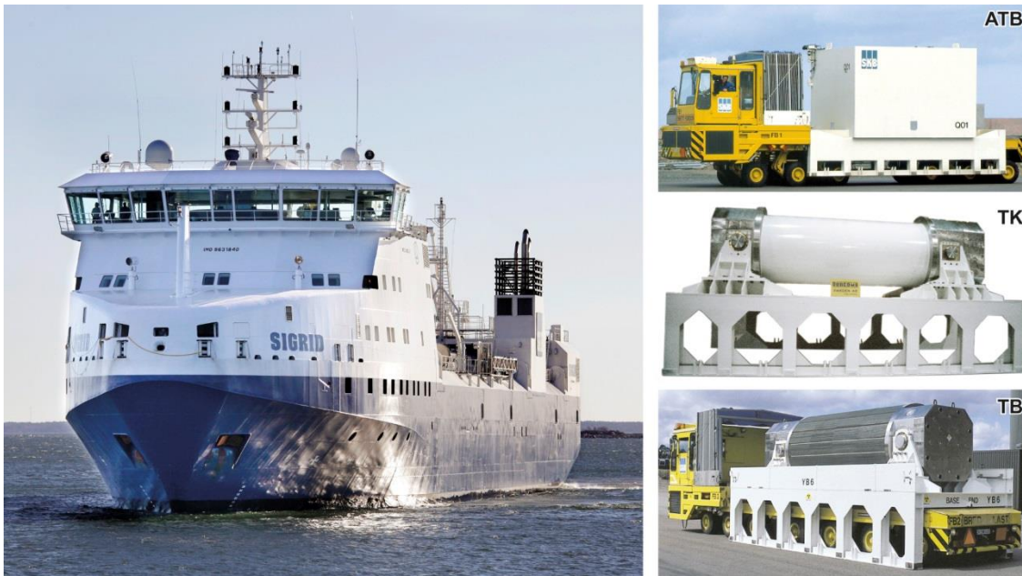
Figur 804-1 M/s Sigrid samt transportbehållare för kortlivat radioaktivt avfall (ATB), för hårdkomponenter (TK) och använda bränsleelement (TB).
