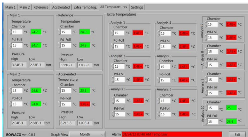
Fig 14. Del av loggningsprogrammet utvecklat av ROWACO. Bilden visar ett test av temperaturövervakningen och tryckövervakningen. I denna bild är inte alla termoelement anslutna (röda rutor, som annars anger avvikelse från börvärde).
